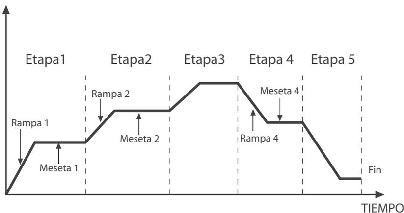
Para crear o modificar un programa se deben cargar en el instrumento: El número de programa, el número de etapas de ese programa, la velocidad de cada rampa, la temperatura y tiempo de cada meseta. Esto se realiza de forma simple e interactiva. El instrumento indica en la pantalla, mediante mensajes de texto, los valores de los parámetros que deben ser cargados.
